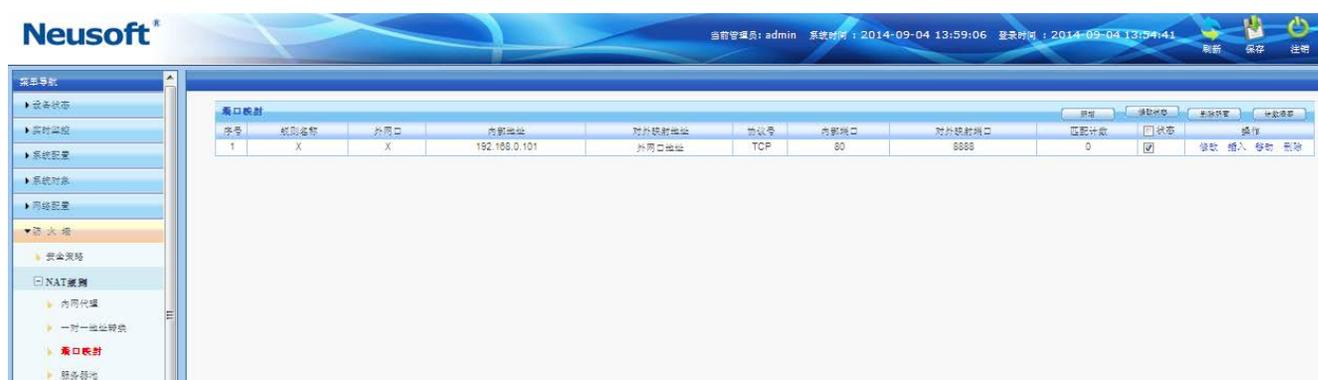
图126. 端口映射
